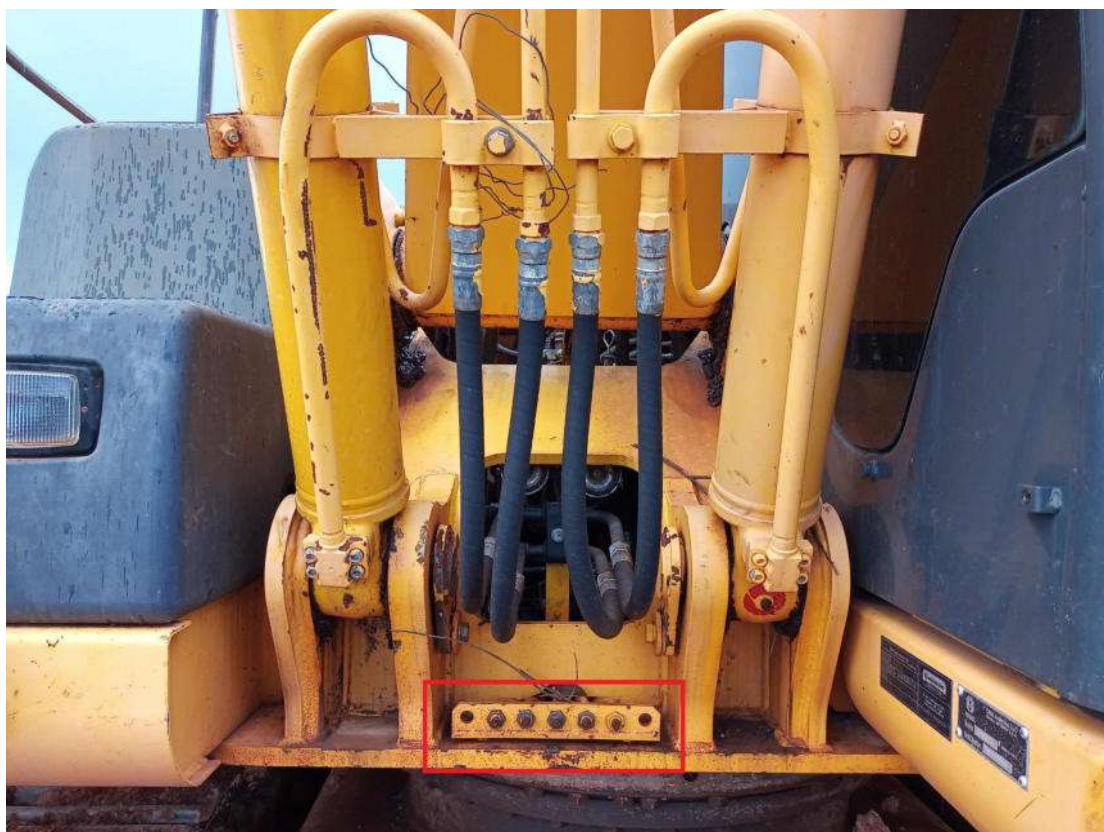
Imagem 03 – Pontos de Lubrificação com Graxa
